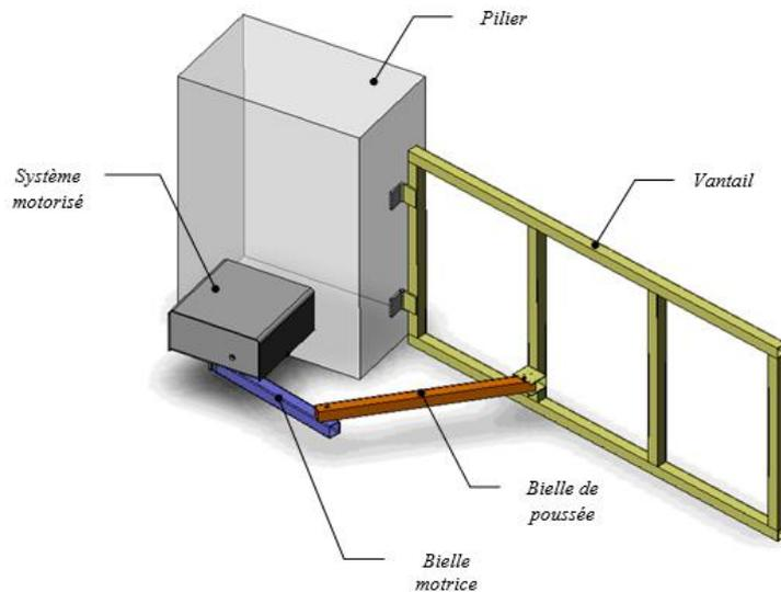
L'ouvre-portail « DRAGON » est un système automatisé permettant d'ouvrir un vantail sans intervention directe de l'utilisateur.
